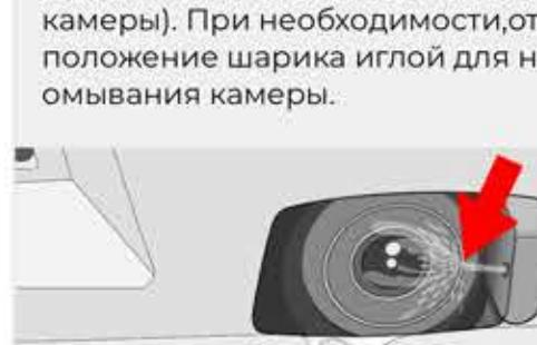
**11** Включите омыватель заднего стекла, убедитесь в отсутствии течей. Сборка авто осуществляется в обратной последовательности (при сборке убедитесь, что устанавливаемые шланги не пережимают шланги подачи жидкости к омывателю камеры). При необходимости, отрегулируйте положение шарика иглой для наилучшего омывания камеры.
