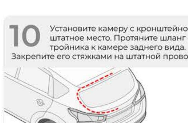
**10** Установите камеру с кронштейном в штатное место. Протяните шланг от тройника к камере заднего вида. Закрепите его стяжками на штатной проводке
