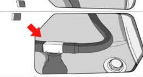
**3** Отсоедините разъём проводки подсветки номера и кнопки открывания багажника. Отсоедините его от кузова. **Не закрывайте крышку багажника, пока не подключите его обратно.**
