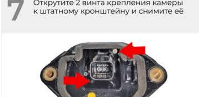
**7** Открутите 2 винта крепления камеры к штатному кронштейну и снимите её
