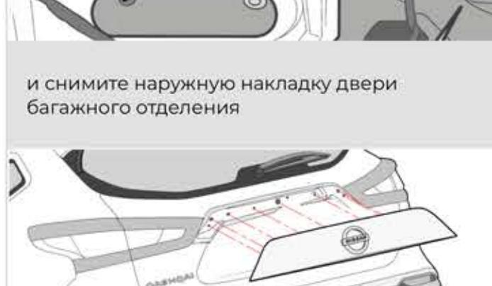
и снимите наружную накладку двери багажного отделения
